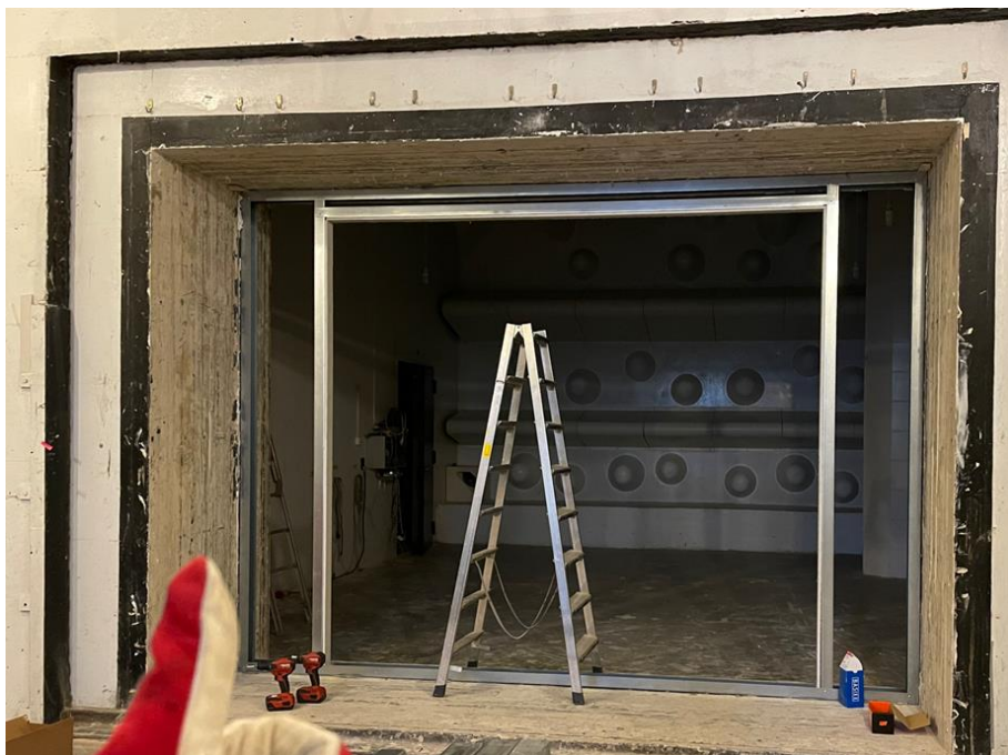
Standard-70 mm stålreglar i omgivende alm. gips-vægge og -skørt mod top.
