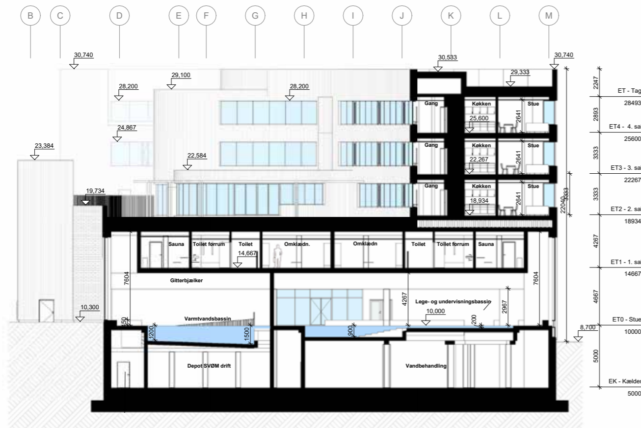
Tværsnit B-B Varmvandsafsnit og omklædning / boligfløj
